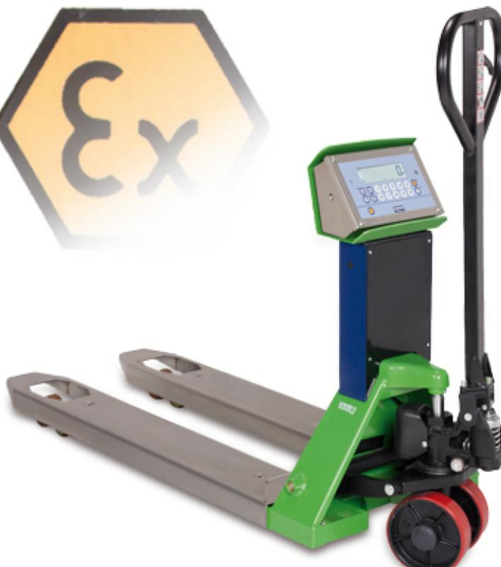
Transpaleta con pesaje electrónico integrado, adecuado para áreas peligrosas clasificadas como zonas con riesgo de explosión (ZONA 2 y 22) con modo de protección según Ex II 3GD IIC T6 T130°C X. La detección del peso por 4 células de carga inoxidable IP68, certificadas ATEX, garantiza precisión en cualquier condición de trabajo. Disponible también en versiones HOMOLOGADAS CE-M.
